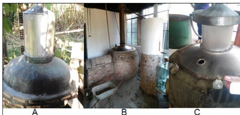
Figura 3: Alambiques de, (A): Cobre e aço inoxidável; (B) Cobre; (C) Aço inoxidável Fonte: Arquivo próprio (2017).
