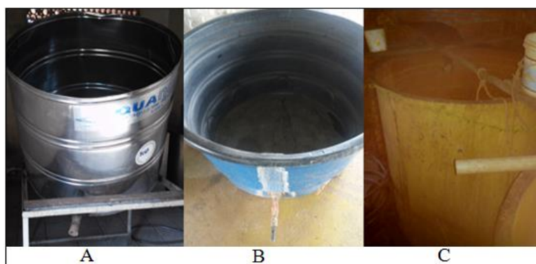
Figura 2: Dornas de fermentação, confeccionadas em, (A): Aço inoxidável; (B): Fibra de vidro; (C): Chapa de ferro.
