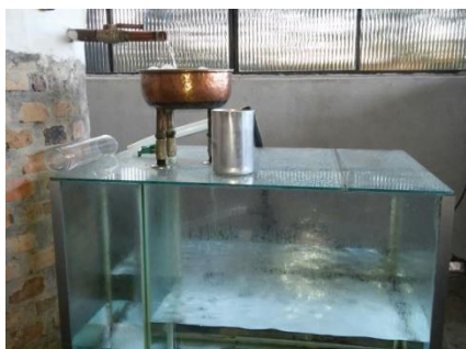
Figura 8: Caixa de separação. Fonte: Arquivo próprio (2017).
