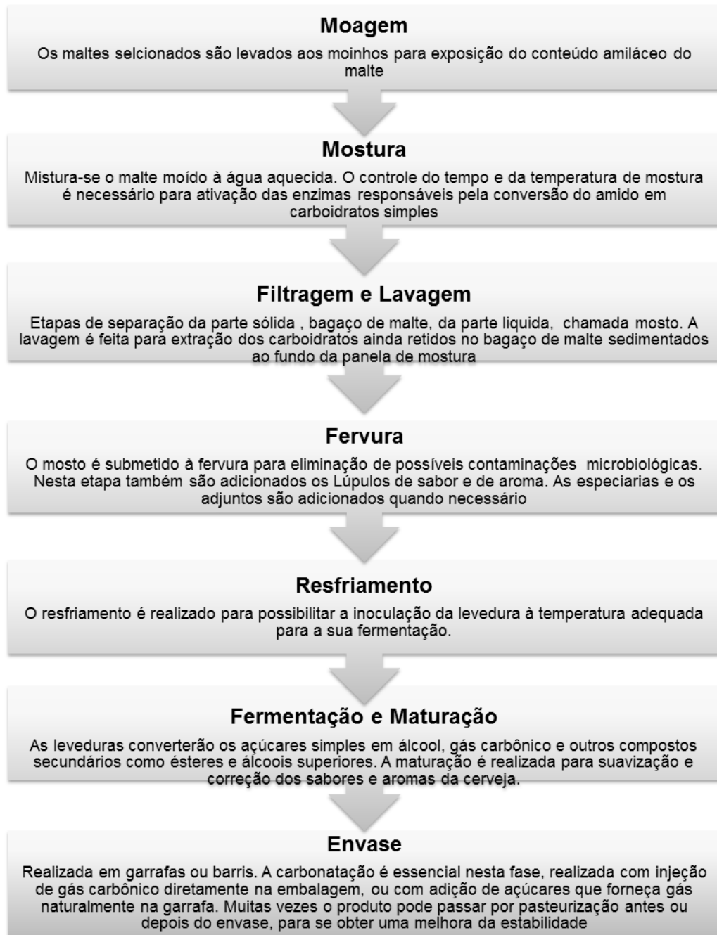
Figura 3. Fluxograma de produção de cervejas. Fonte: Adaptado de BRIGGS et al., 2004; KUNZE, 1999; MORADO, 2009.
